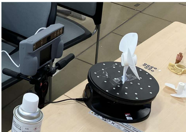
図1 3D スキャナーによるスキャニング
