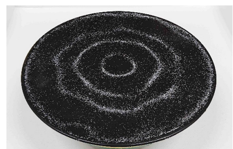
図4 声によるクラドニ図形作成
